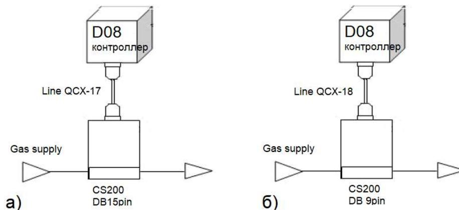
*Рисунок 9. Пример подключения контроллера D08 и РРГ CS330 в зависимости от источника питания и разъема*
