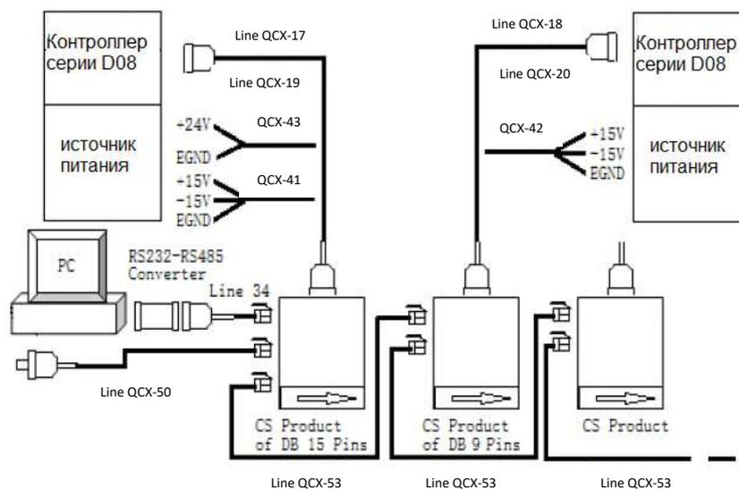
Рисунок 10. Схема подключения ПРГ CS330 к компьютеру и к управляющим контроллерам D08 Sevenstar
