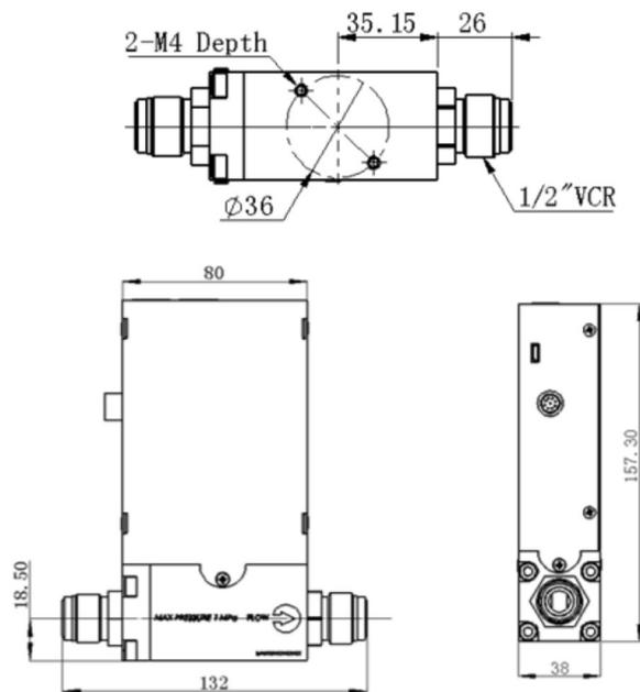
Рисунок 3. Габаритные размеры PPG CS330-C (EtherCAT)
