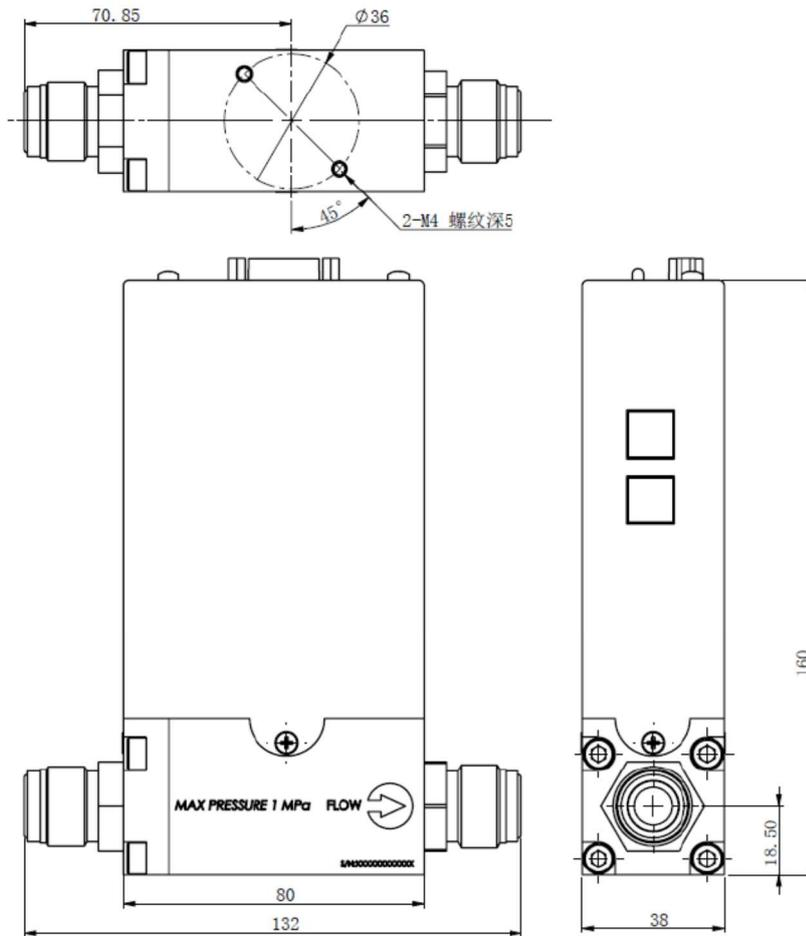
Рисунок 2. Габаритные размеры PPG CS330-C (9 pin и 15 pin sub-D)
