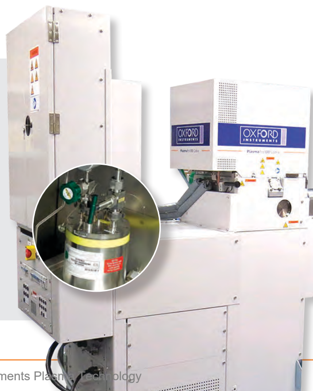
Высококомформное осаждение \text{SiO}_2 из \text{TEOS} с использованием плазмы в \text{O}_2
