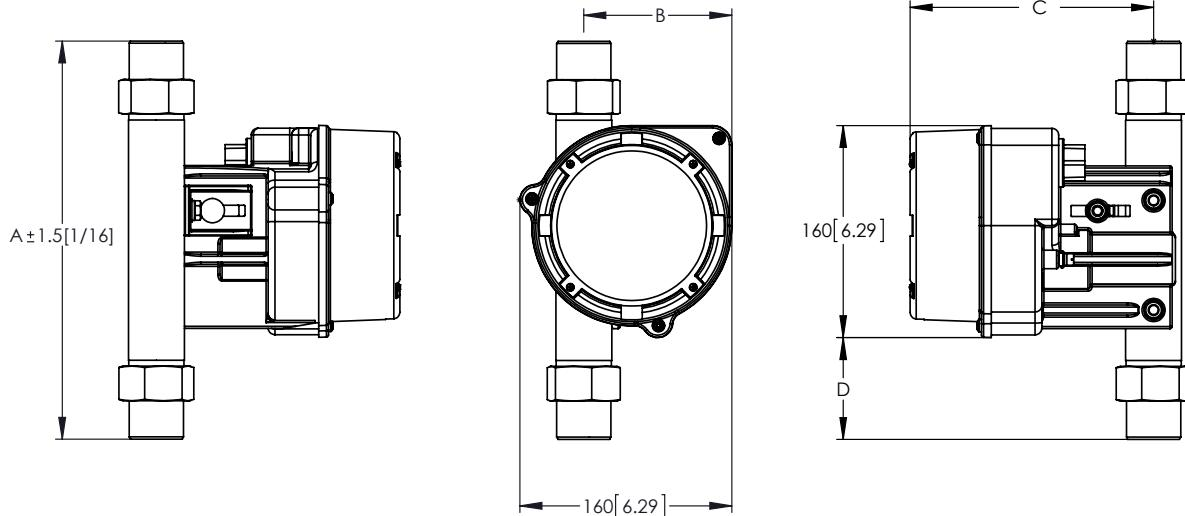
Модель 3809 с индикатором в искробезопасном корпусе с фланцами, мм [дюйм]
