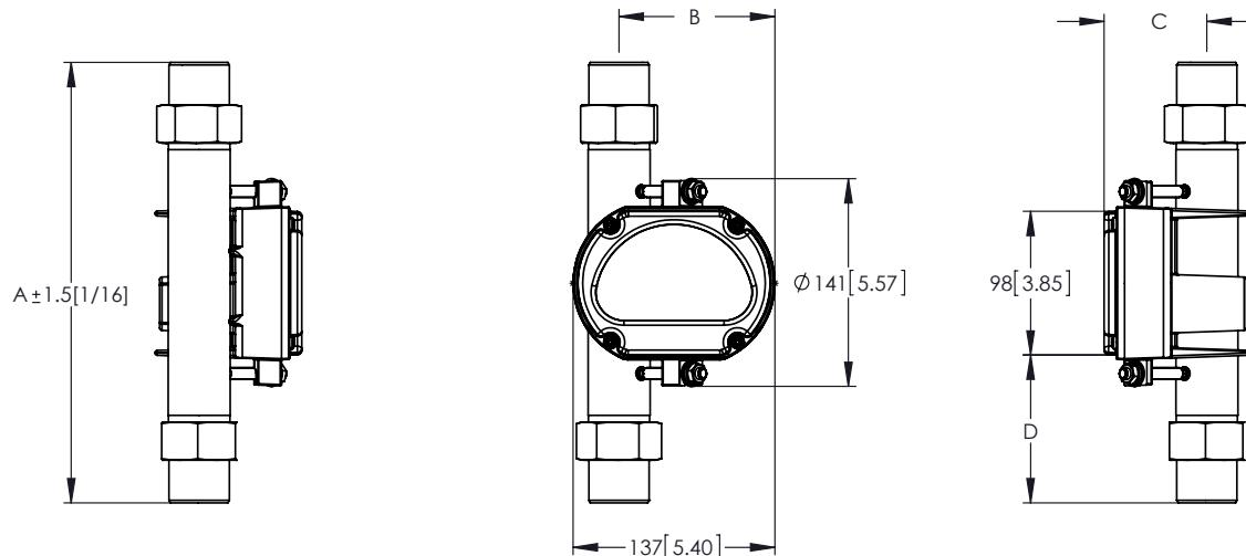
Модели 3809 и 3810 с индикатором в корпусе общего назначения с фланцами, мм [дюйм]
