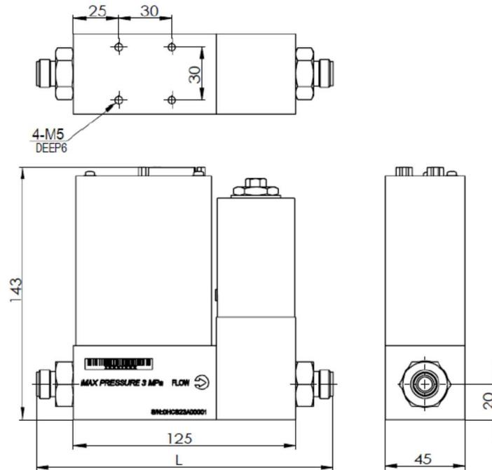
Рисунок 6. Габаритные размеры регулятора расхода газа
