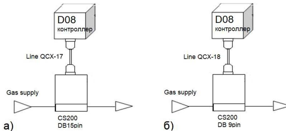
Рисунок 65. Пример подключения контроллера D08 и РРГ CS230 в зависимости от источника питания и разъема
