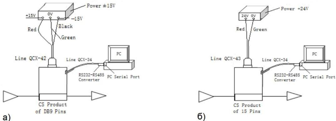
*Рисунок 5. Подключение РРГ CS230 к COM порту компьютера (кабель RJ11- COM порт)
