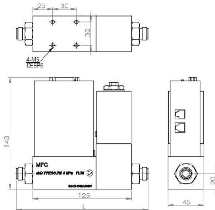
Рисунок 2. Габаритные размеры регулятора расхода газа
