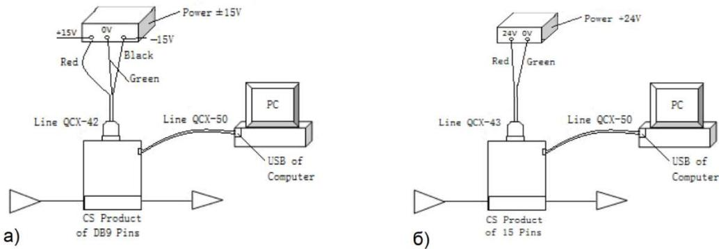
*Рисунок 4. Подключение РРГ CS230 к USB порту компьютера (кабель RJ11- USB порт)
