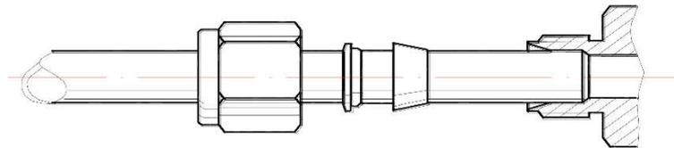
*Рисунок 10. Зажимное соединение*
