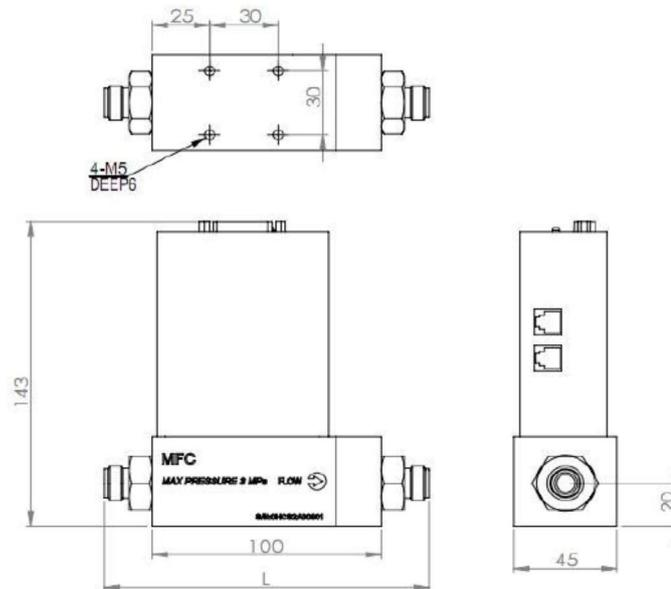
Рисунок 3. Габаритные размеры регулятора расхода газа
