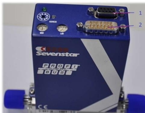
Рисунок 12. Внешний вид и расположение электрических соединений ProfiBus
