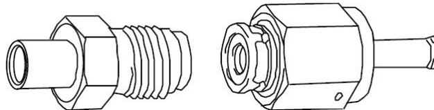
*Рисунок 9. VCR с фиксирующимся уплотнением*
