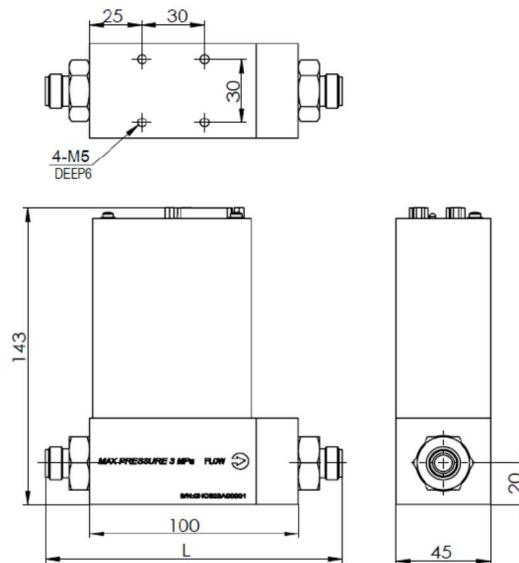
Рисунок 7. Габаритные размеры регулятора расхода газа
