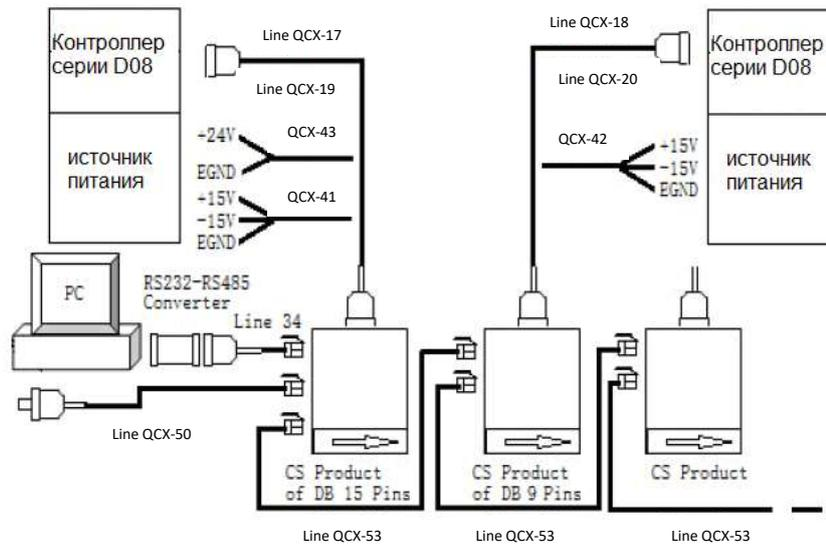
Рисунок 76. Схема подключение PPG CS230 к компьютеру и к управляющим контроллерам D08 Sevenstar
