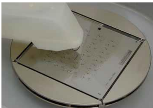
Очистка фотошаблона мегазвуковой насадкой
