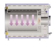
установках YES-PB-CP применена технология вертикального потока газа в рабочей зоне технологической камеры. Пода и откачка инертного газа рассчитаны с формирования ламинарного учетом потока вдоль поверхности обрабатываемых подложек. В большинстве это гарантирует практическое отсутствие привнесенных частиц на поверхность процессе обработки.
