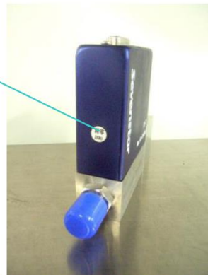
Рисунок 9. Расположение потенциометра нуля на D07-7K
